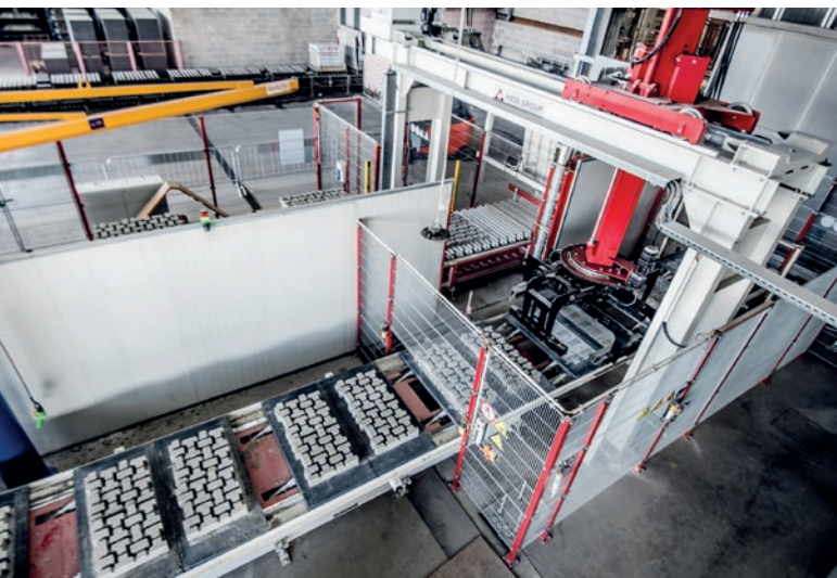
Na linii suchej zautomatyzowany paletyzator Servo Pak 700-2 układa gotową kostkę brukową wydajnie i precyzyjnie.
