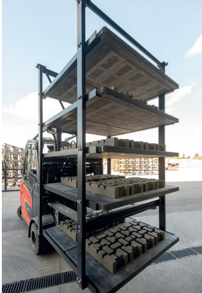
Pięciopoziomowe regały załadowane świeżo wyprodukowanymi blockami betonowymi, gotowymi do dojrzewania.
