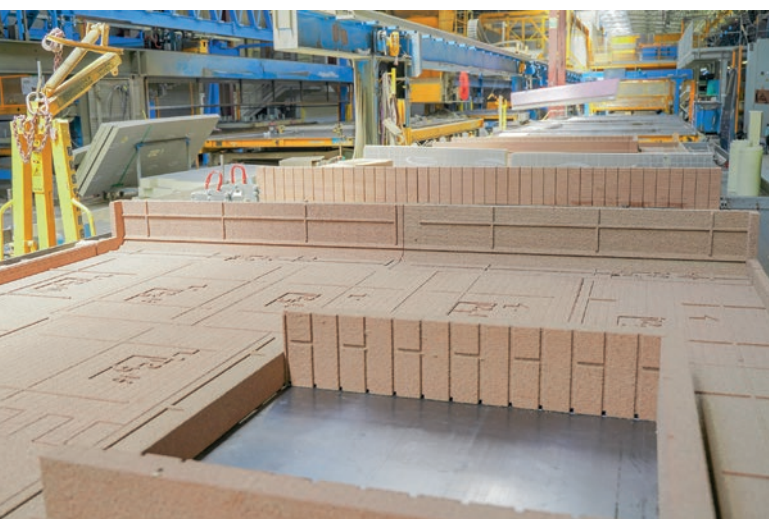
Element ścienny projektu Pareus, wyprodukowany w technologii druku 3D.
