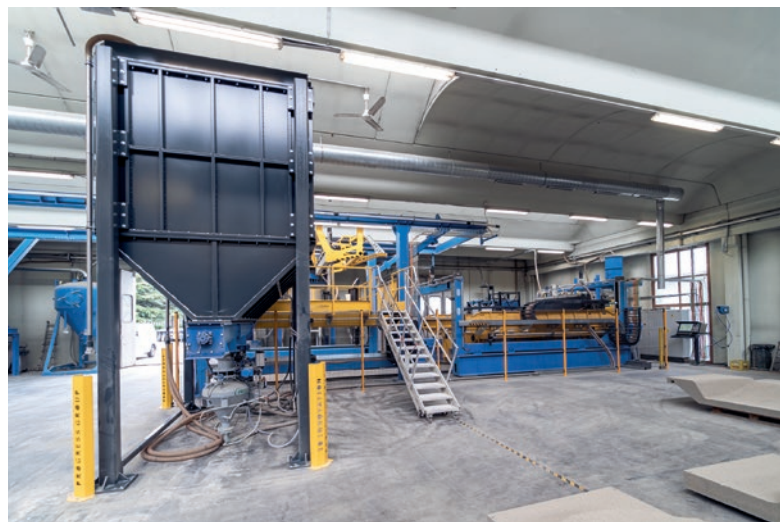
Drukarka 3D do betonu wyznacza nowe standardy w budownictwie prefabrykowanym.
