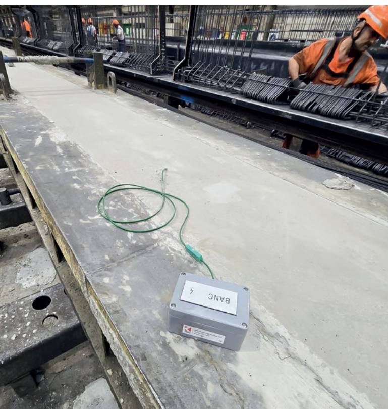
Wytrzymały, magnetyczny, bezprzewodowy przekaźnik temperatury (w szarej obudowie) z termoparą typu K do pomiaru temperatury wewnętrznej betonu.
