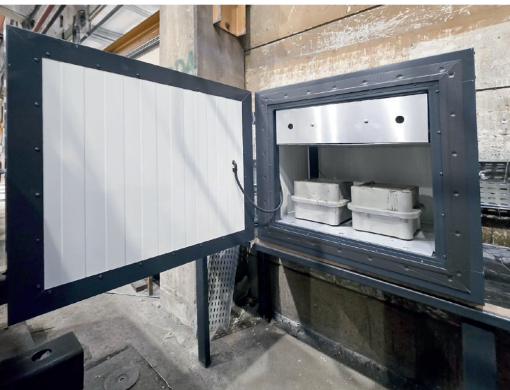
Izolowana komora klimatyczna Match-Cure z próbkami i pomiarem wewnętrznej temperatury betonu.
