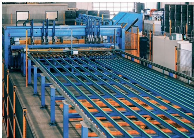
Il nuovo impianto per la produzione di reti elettrosaldate M-System BlueMesh in azione.
