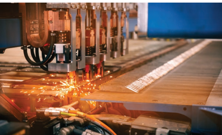
Modernissima tecnologia di saldatura per una produzione costante nella produzione di reti elettrosaldate.
