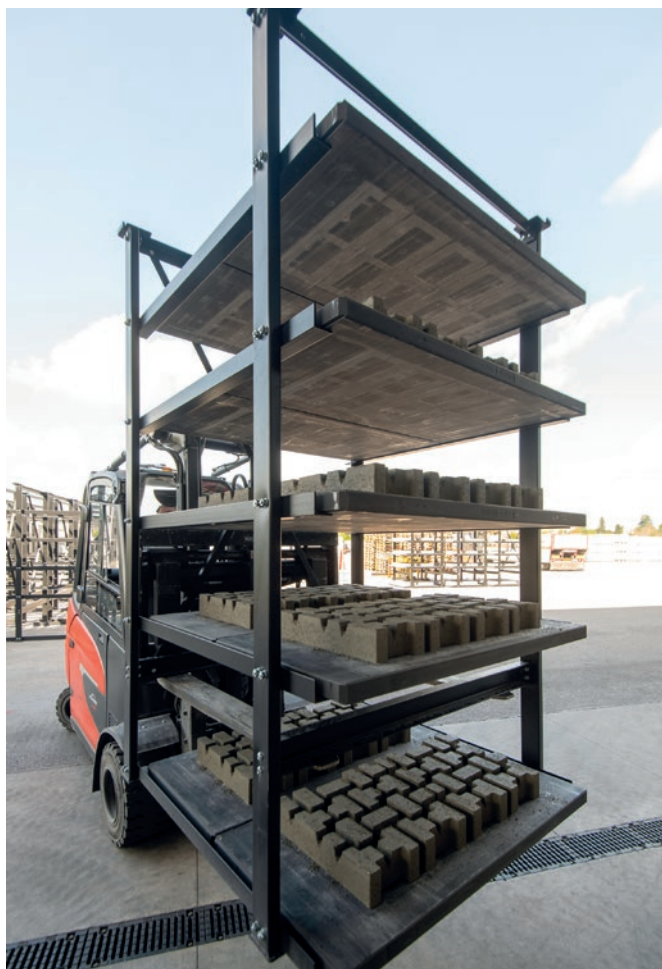
Scaffale a cinque piani, carico di blocchi di calcestruzzo appena prodotti, pronti per la stagionatura
