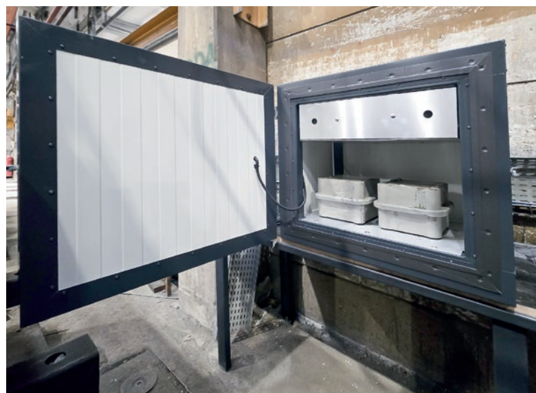
Camere climatiche Match Cure isolate con provini e misurazione della temperatura interna del calcestruzzo.
