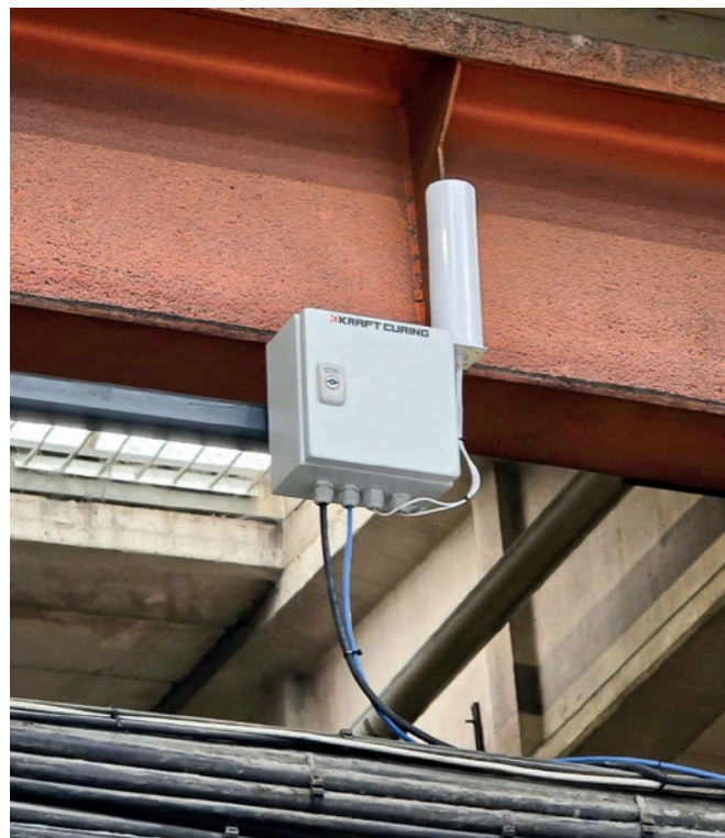
Un ripetitore senza fili che viene collocato in tutto l'impianto o sull'area aziendale per garantire un'intensità sufficiente del segnale su una vasta area. Cavo per termocoppia per misurare la temperatura interna del calcestruzzo.
