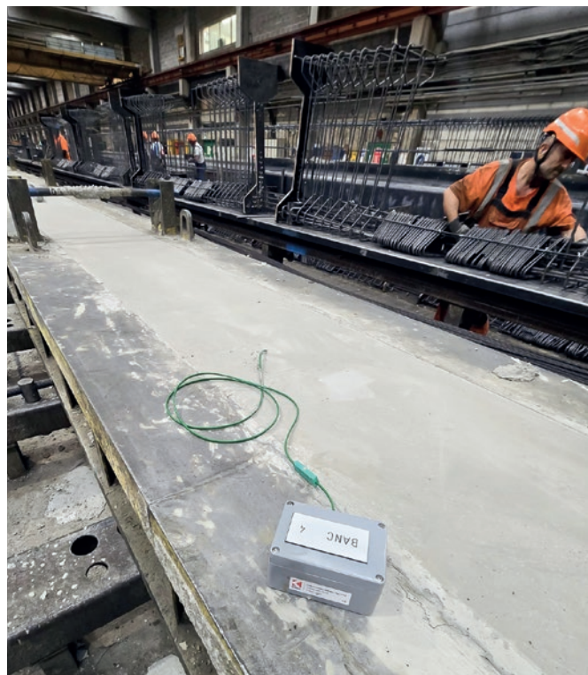
Trasmettitore di temperatura magnetico, senza fili (alloggiamento grigio) con cavo per termocoppia K per misurare la temperatura interna del calcestruzzo.
