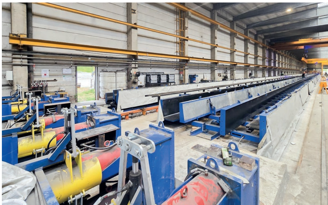
Produzione del calcestruzzo precompresso con le camere climatiche Match Cure
