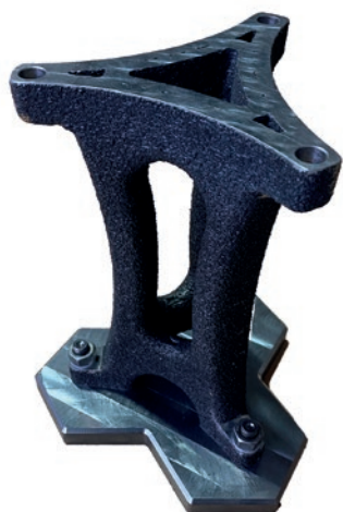
Poinçon à structure gyroïde pour une répartition optimisée des forces
