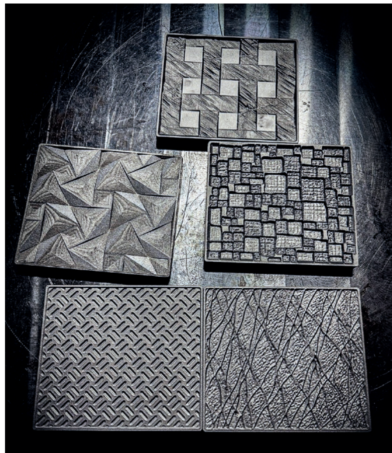
Empreintes de contre-moule imprimées en 3D
