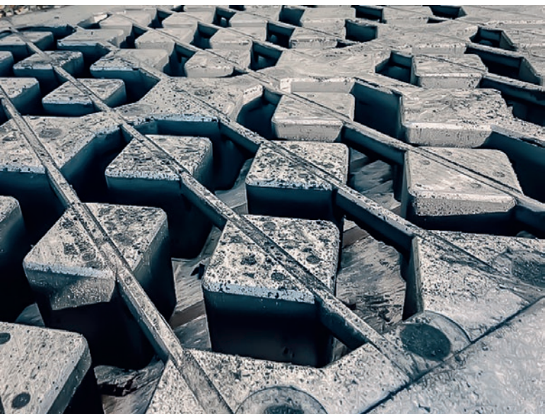
Noyaux imprimés sans soudure intégrés dans l'insert du moule
