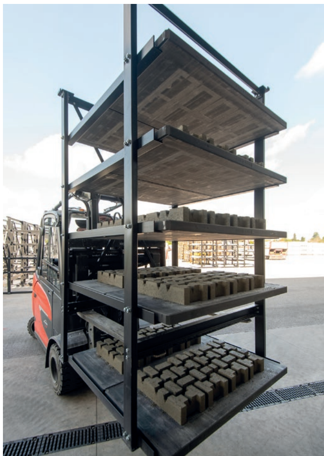
Rayonnage à cinq étages, chargé de produits en béton frais, prêts pour la cure
