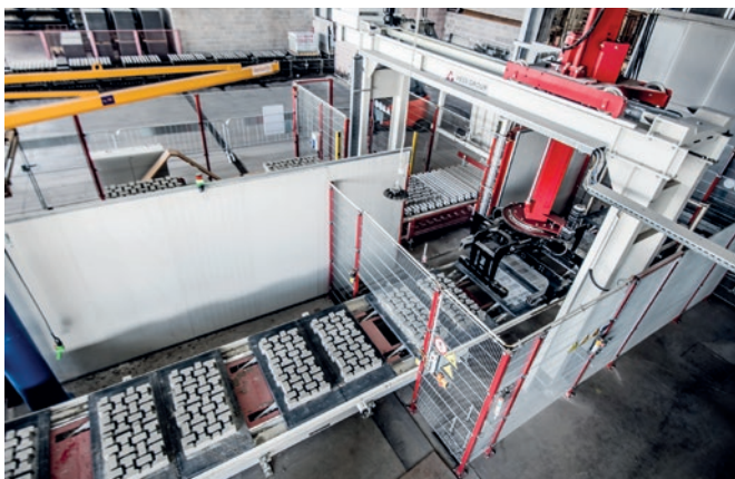
Côté sec, le cubeur Servo Pak 700-2 empile les pavés finis avec efficacité et précision.
