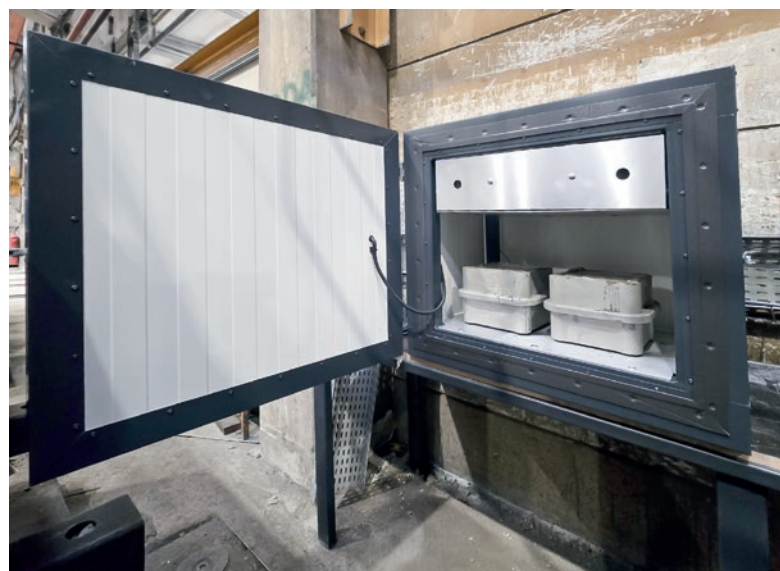
Chambre climatique Match-Cure isolée avec échantillon et mesure de la température interne du béton.
