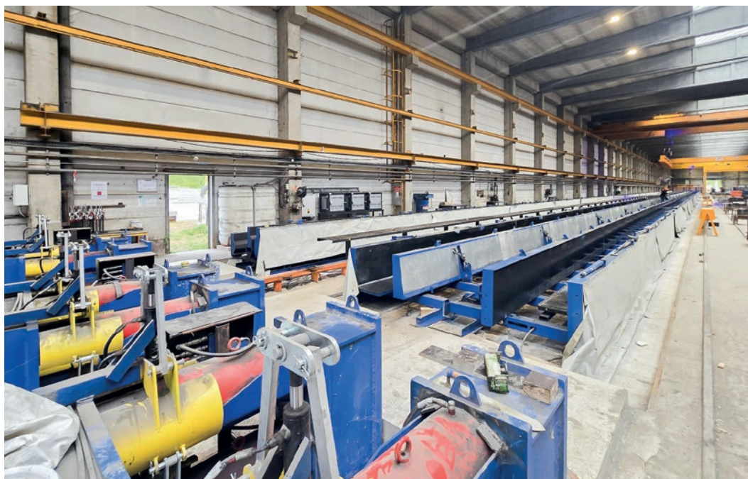
Fabrication de béton précontraint avec des chambres climatiques Match-Cure
