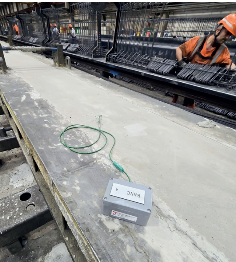
Transmetteur de température robuste, magnétique et sans fil (boîtier gris) avec câble thermocouple de type K pour mesurer la température interne du béton.
