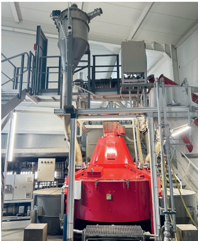
Mezcladora planetaria HPGM 2250
