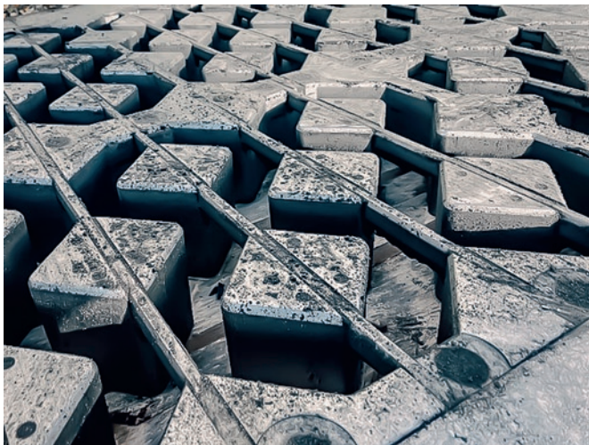
Núcleos impresos sin cordón de soldadura en el inserto
