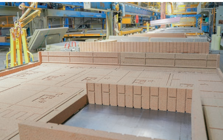
Elemento de muro impreso en 3D para el complejo Pareus.
