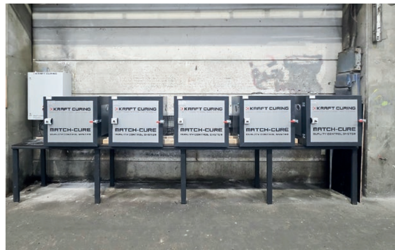
Cámaras climáticas Match-Cure para un total de cinco zonas de producción/lechos/moldes/mesas.
