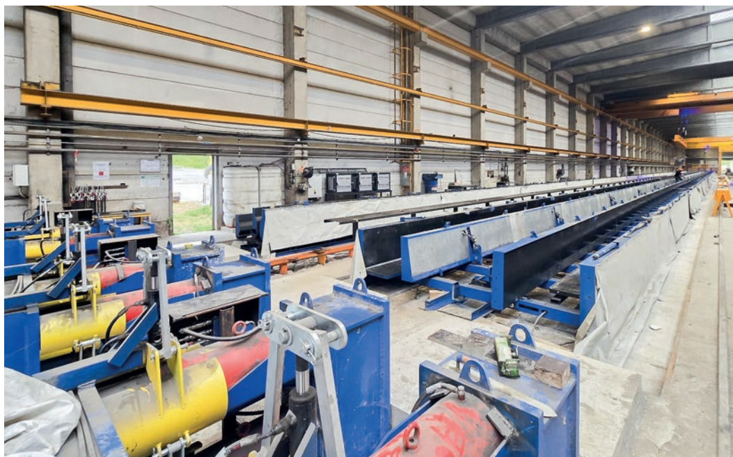
Producción de hormigón pretensado con cámaras climáticas Match-Cure
