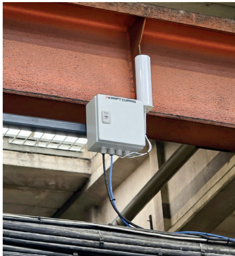
Repetidor inalámbrico, colocado en toda la planta o en las instalaciones de la fábrica para asegurar una intensidad de señal suficiente en una zona amplia. Cable de termopar para medir la temperatura interna del hormigón.
