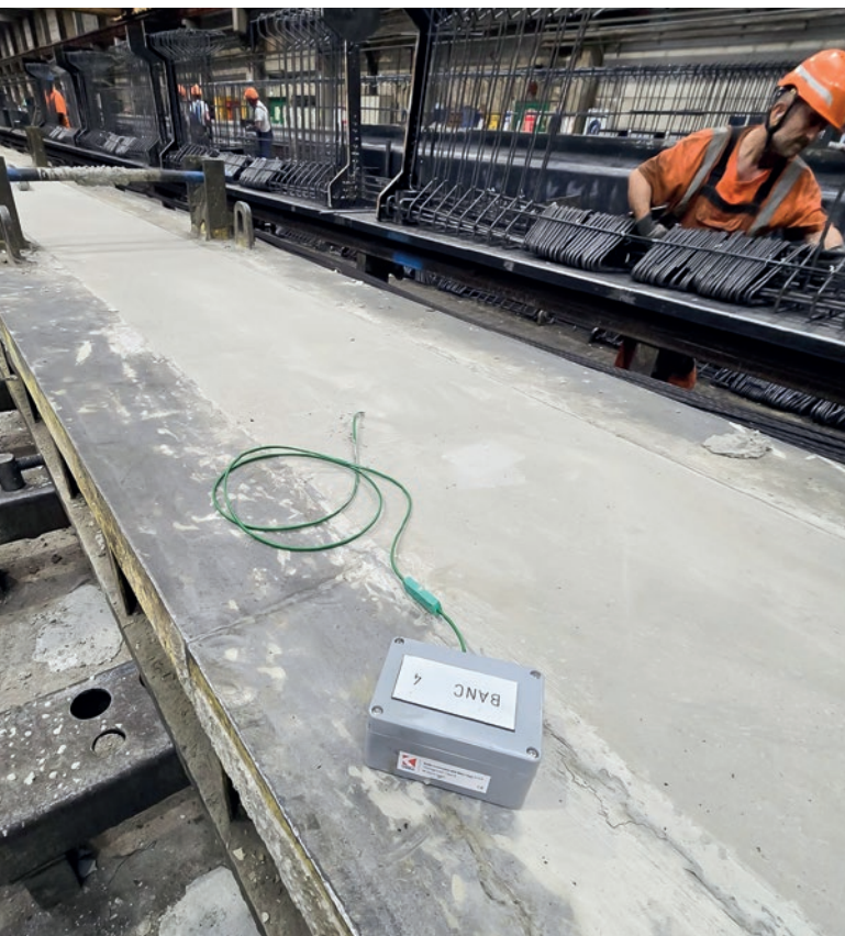
Transmisor de temperatura robusto, magnético e inalámbrico (carcasa gris) con cable de termopar tipo K para medir la temperatura interna del hormigón.
