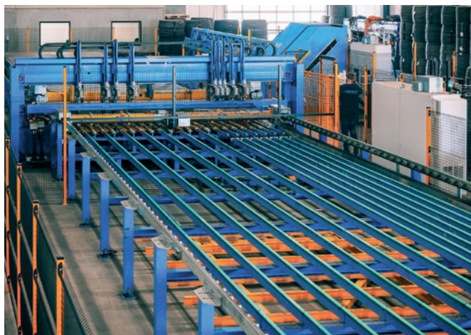
La nueva máquina soldadora de mallas M-System BlueMesh en funcionamiento
