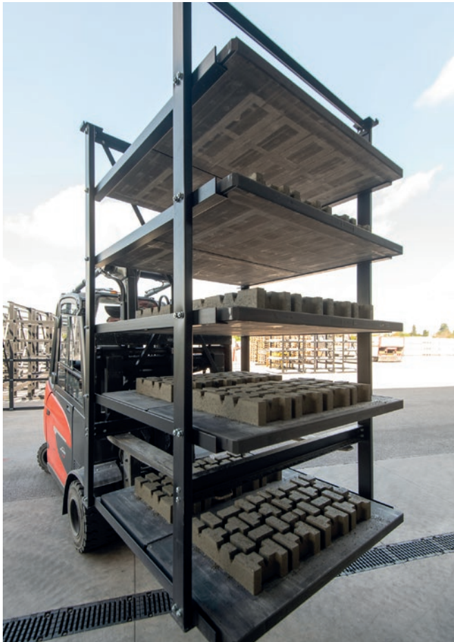
Fünfstöckiges Regal, beladen mit frisch produzierten Betonsteinen, bereit zum Aushärten
