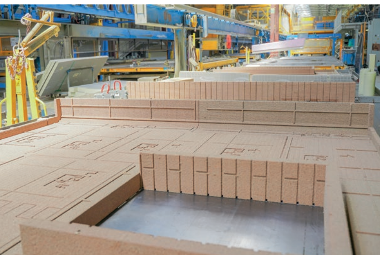
3D-gedrucktes Wandelement für das Pareus Resort
