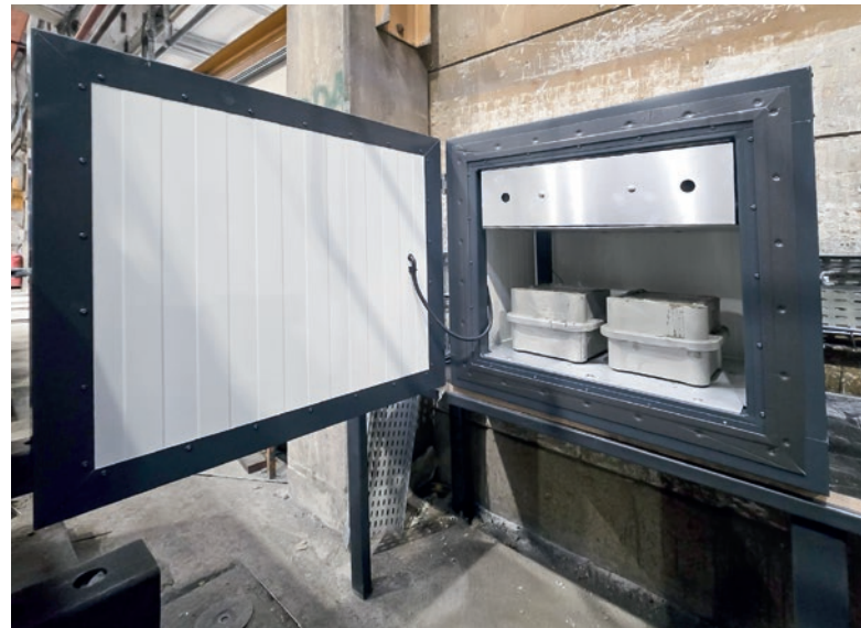
Isolierte Match-Cure-Klimakammer mit Prüfkörper und Messung der inneren Betontemperatur
