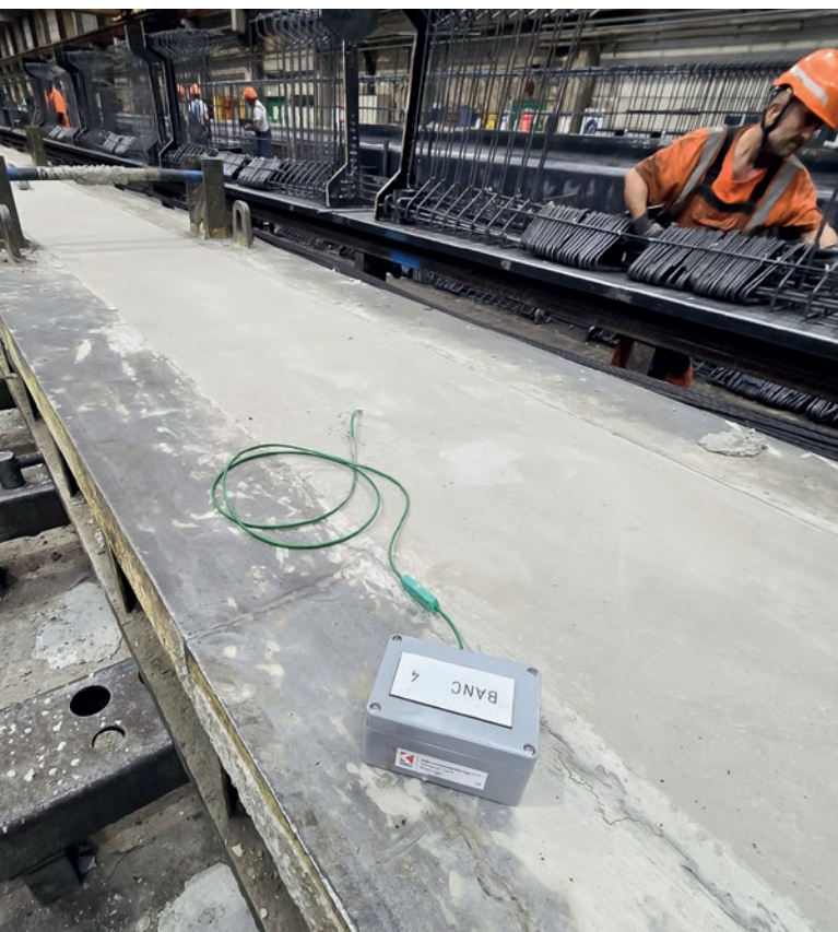
Robuster, magnetischer, drahtloser Temperaturtransmitter (graues Gehäuse) mit Typ-K-Thermoelementkabel zur Messung der Innentemperatur des Betons
