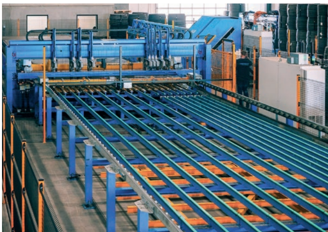
Die neue Mattenschweißanlage M-System BlueMesh im Einsatz
