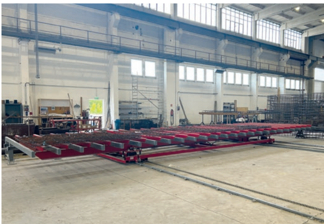
Spezieller Übergabewagen zum Transport der Bewehrung zur Umlaufanlage
