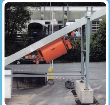
Drehkübel 3.500 l in Steigung 32° = 60%
