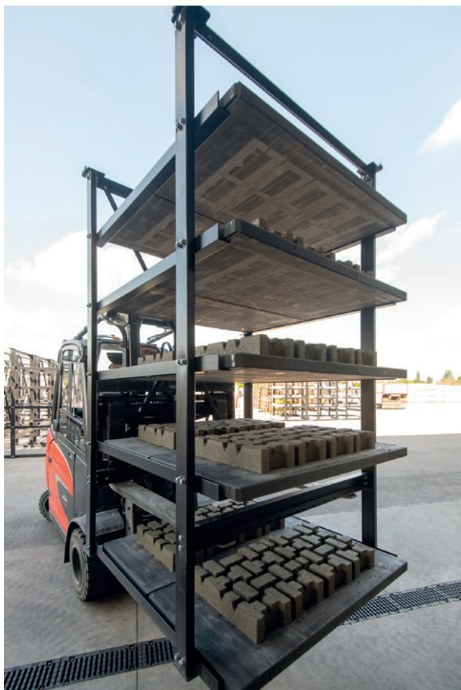
满载新成型混凝土砌块的五层养护架
