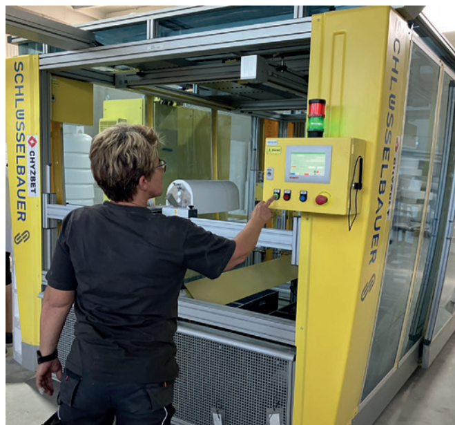
По нажатию кнопки машина запускает процесс раскроя
