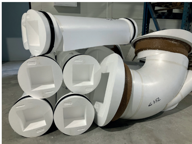
Негатив лотка из пенополистирола в сборе, готовый к укладке в форму для заливки
