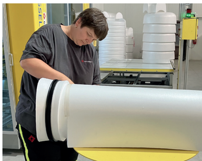
Установка формообразователей с интегрированным уплотнением
