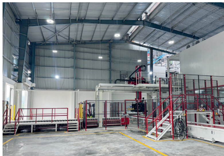
Пакетировщик Servo 700-2 со штанговым конвейером и ленточным транспортером из двутавровых швеллеров
