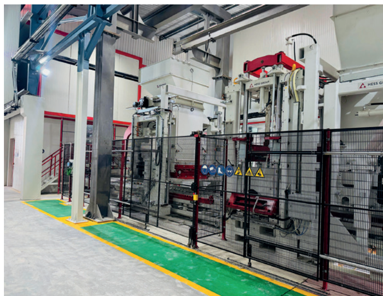
Вибропресс RH2000-4 VA с открытым модулем для лицевого бетона
