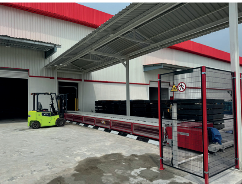
Ленточный транспортер из двутавровых швеллеров для вывоза готовых пакетов с блоками из цеха
