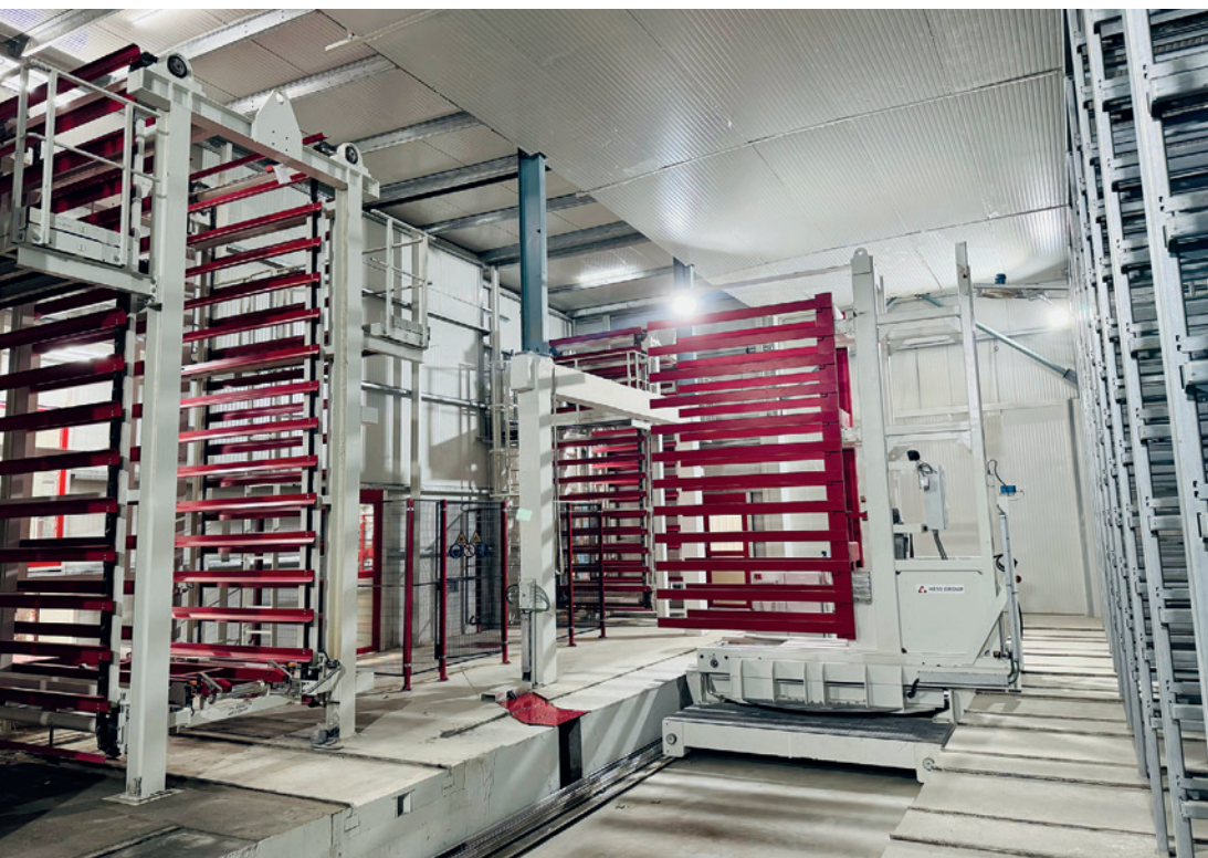
Зона выдержки с подъемно-опускными штабелерами и транспортной группой
