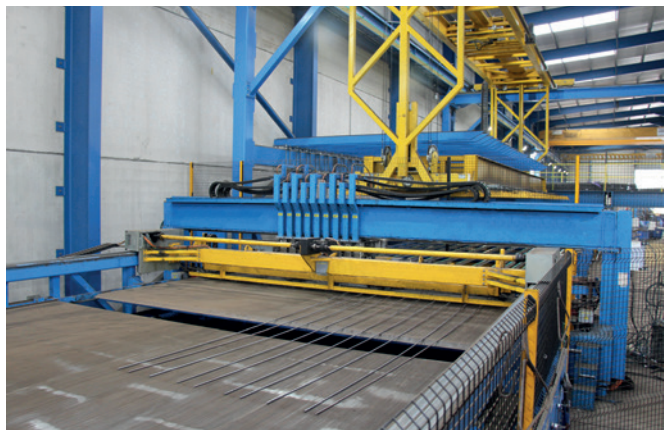
Сеткосварочная установка M-System Evolution в Байли повышает операционную эффективность
