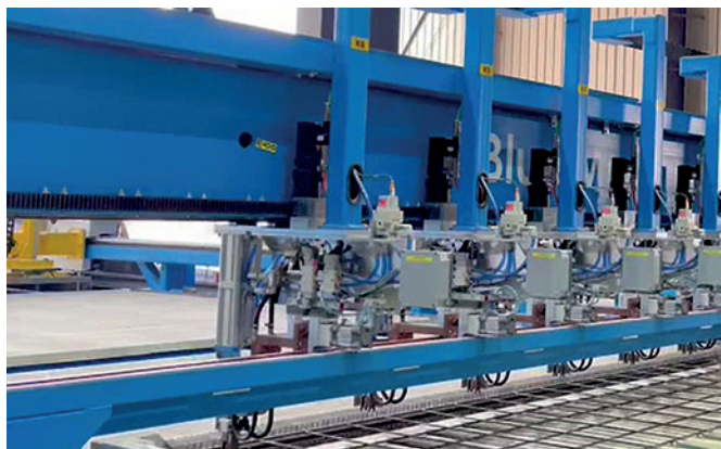
Система M-System BlueMesh на порядок повысила точность производства арматурных сеток на заводе Gulf Precast
