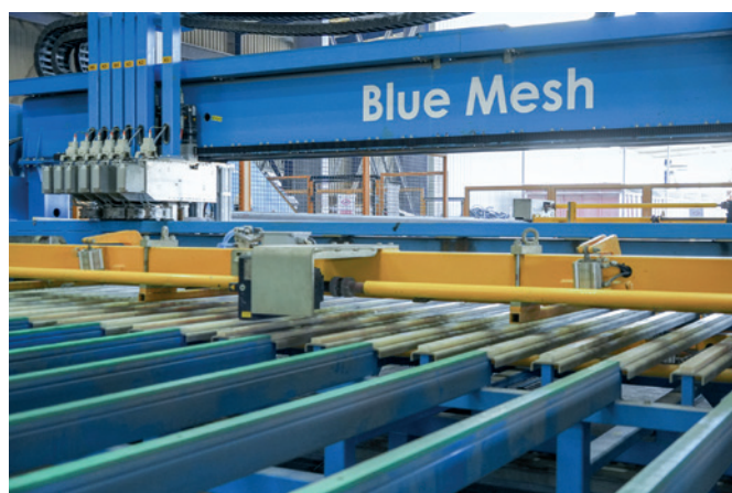
Автоматическая сварка сеток позволяет снизить объем отходов, одновременно увеличивая скорость и качество выпускаемых изделий
