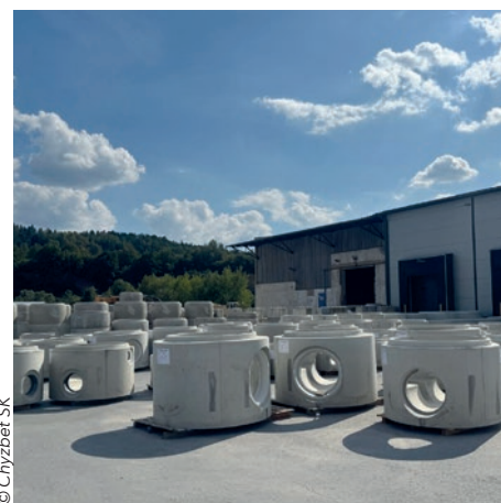
Produkowane na zamówienie monolityczne podstawy studzienek w magazynie.
