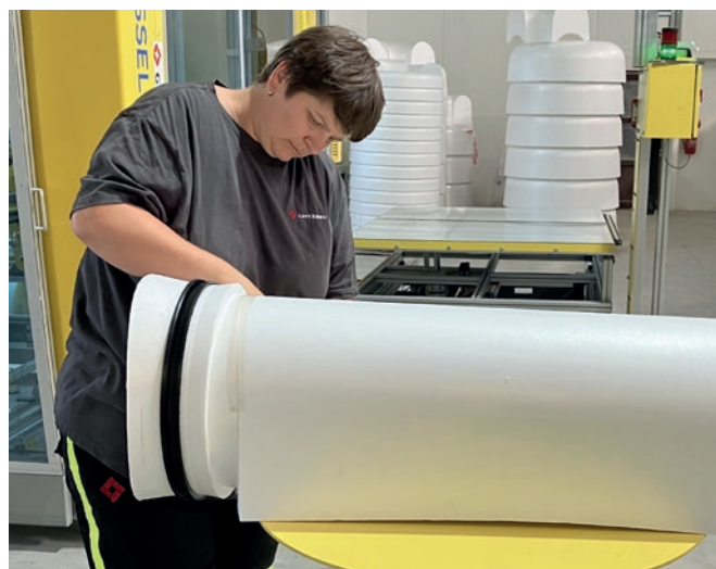
Montaż wkładek formujących ze zintegrowanymi uszczelkami.
