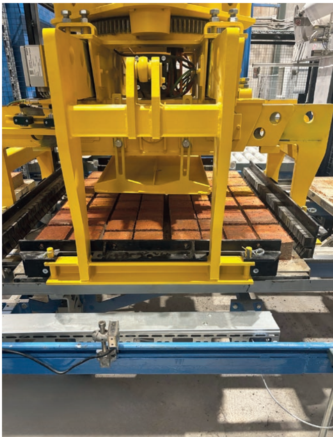
Duża siła trzymania i zróżnicowane funkcje: chwytak Masa i jego mechanizm obrotowy.
