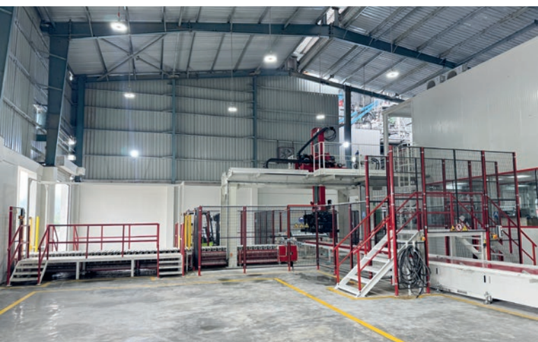
Paletyzator Servo 700-2 z podajnikiem zapadkowym i przenośnikiem płytkowym.
