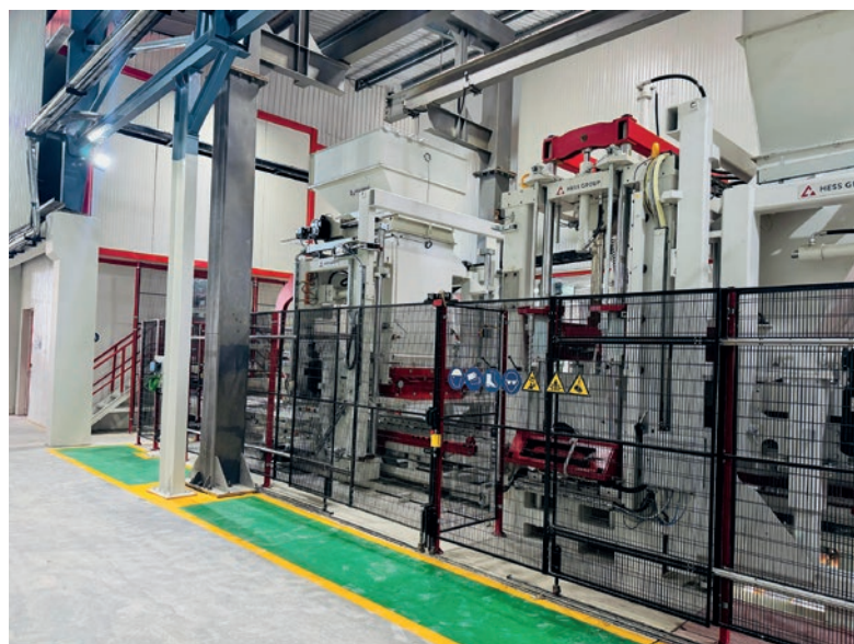
RH2000-4 VA z otwartym zasypem mieszanki licowej.
