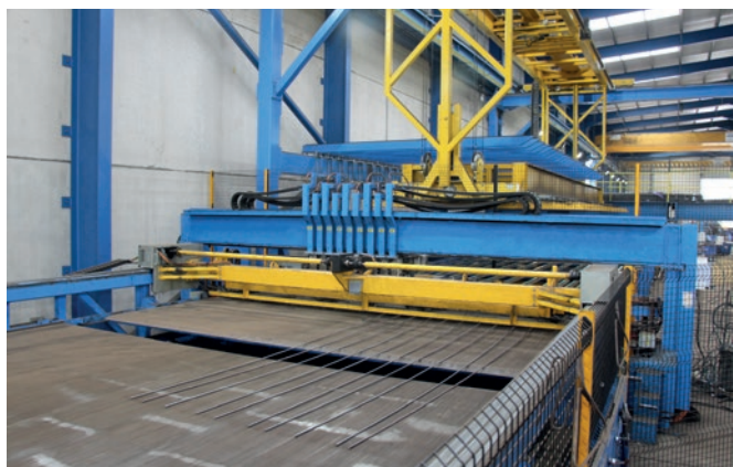
Zgrzewarka do siatek M-System Evolution w zakładzie w Byley znacząco zwiększa wydajność produkcji.
