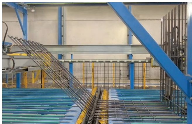
Dwa oddzielne systemy gięcia umożliwiają produkcję wielkoformatowych koszy do ciężkich prefabrykatów betonowych.
