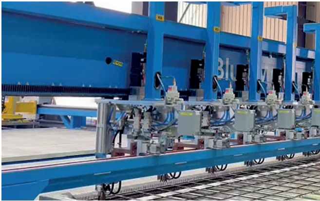
M-System BlueMesh rewolucjonizuje produkcję siatek w zakładzie Gulf Precast, zapewniając większą precyzję.
