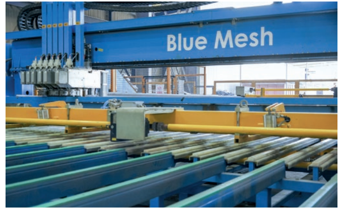
Automatyczne zgrzewanie siatek zmniejsza ilość odpadów, jednocześnie zwiększając szybkość i jakość produkcji.
