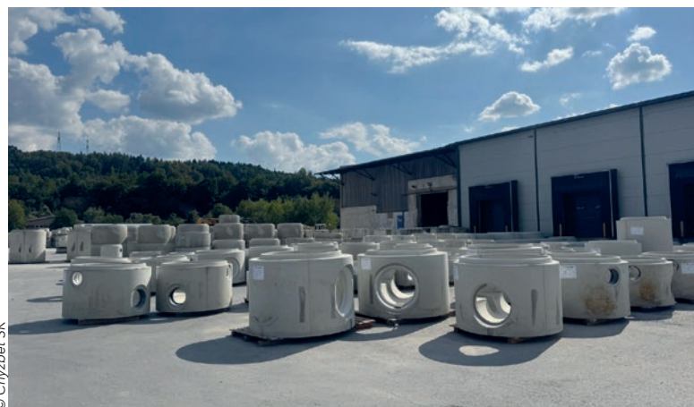
Bases para pozos monolíticas y fabricadas por encargo en el almacén
