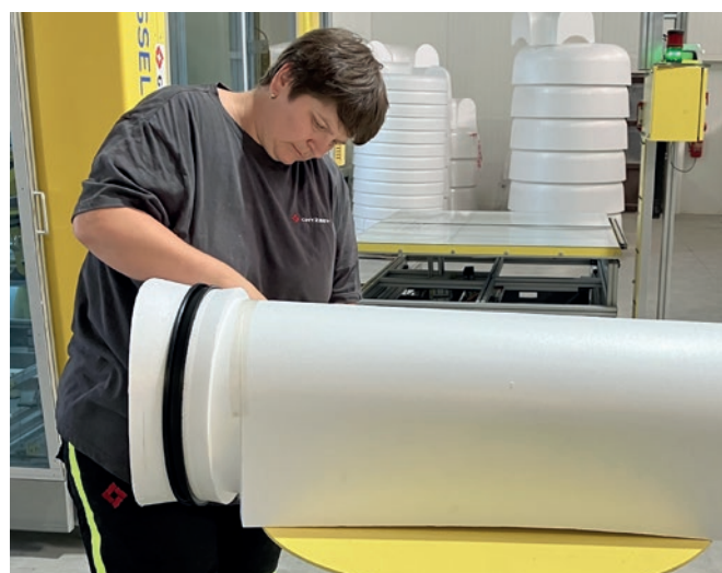
Montaje de cuerpos conformados con juntas integradas
