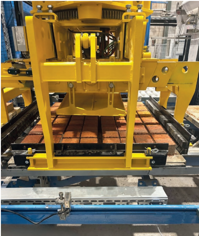
Potente y versátil: cesta de pinzas y mecanismo giratorio de Masa
