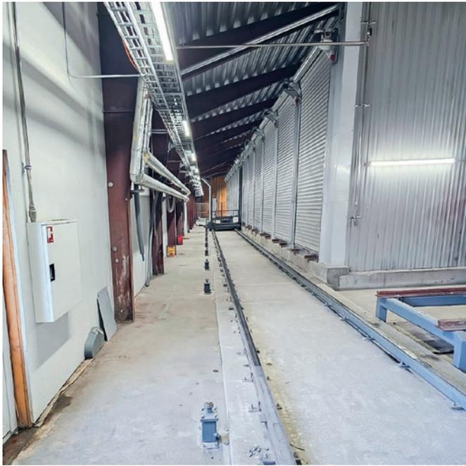
Las 13 nuevas cámaras de curado FIFO con puertas enrollables de aluminio motorizadas y aisladas
