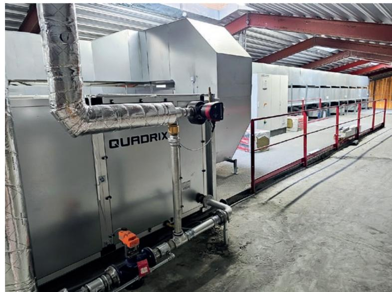
El sistema de curado de hormigón Quadrix acelera el proceso de curado mediante la aportación controlada de calor y humedad.
