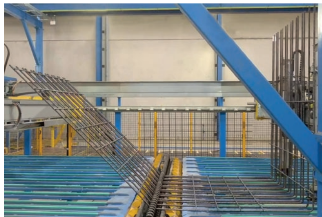
Dos sistemas de doblado separados permiten llevar a cabo la producción de jaulas de gran formato para elementos prefabricados de hormigón pesados
