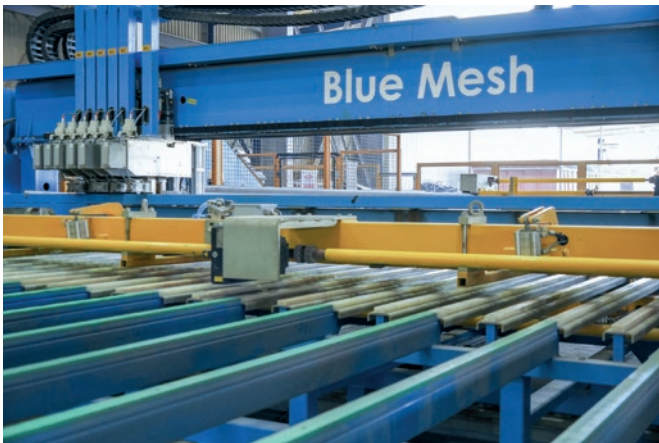
Automatisiertes Mattenschweißen reduziert das Abfallvolumen und verbessert die Produktionsgeschwindigkeit und die Qualität der Produkte.
