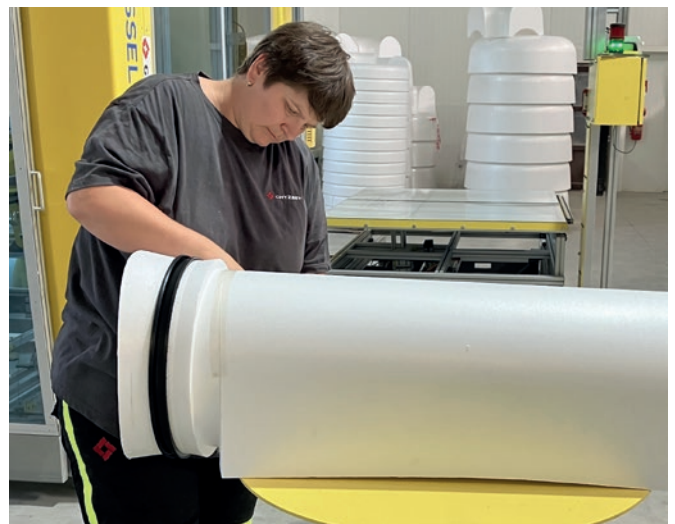
Montage von Formkörpern mit integrierter Dichtung
