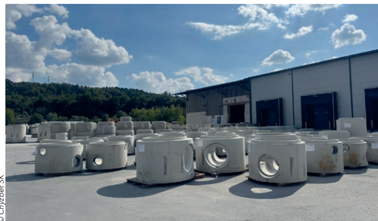
Die auftragsbezogen gefertigten monolithischen Schachtböden am Lager
