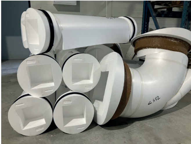
Komplette EPS-Negativgerinne fertig zum Rüsten in Gießformen
