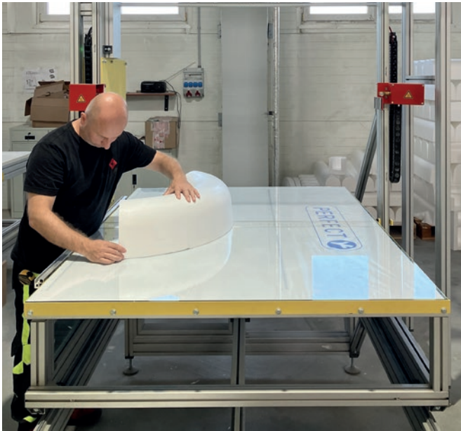
Mit wenigen Handgriffen wird der Formteil eingerichtet.
