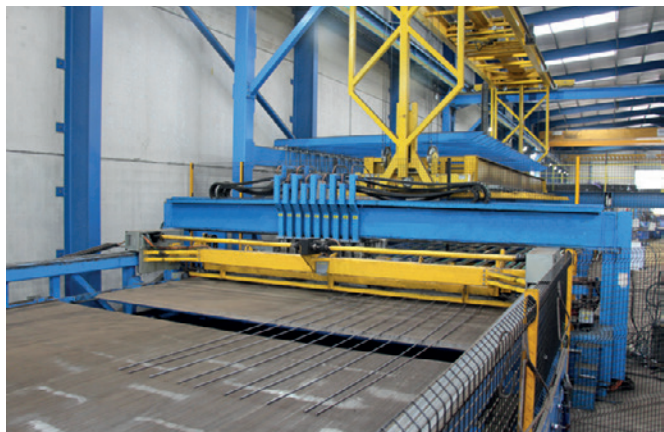
Byley 基地的 M-System Evolution 焊网生产线显著提升运营效率
