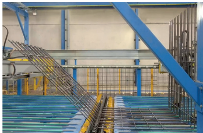
Byley 该生产线配备两套独立弯折系统，可生产重型预制构件专用的大型钢筋笼
