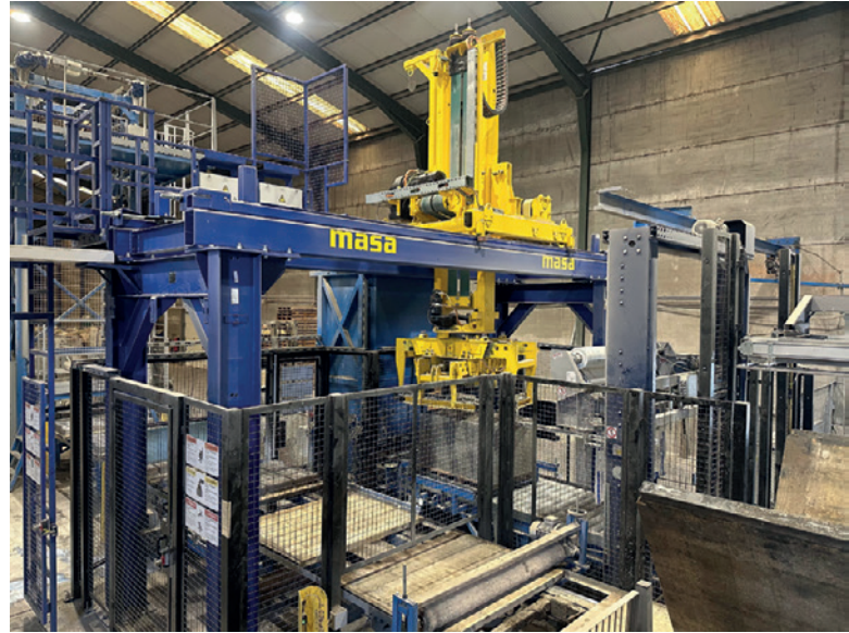
全方位高效：配备安全检修通道的 Masa Cuboter
