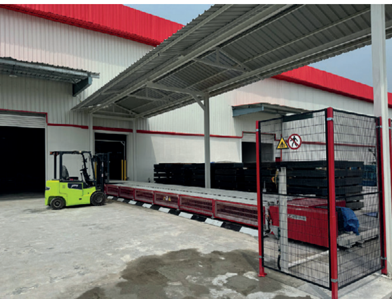
用于运送砌块叠包的板链输送机
