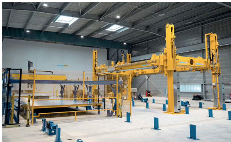
Новое кантовательное устройство Благодаря новому поворотному одновременно поднимает два поддона и поворачивает их на 180°. Это дает возможность нанести на верхнюю часть древеснобетонного элемента несущую конструкцию из обычного бетона
