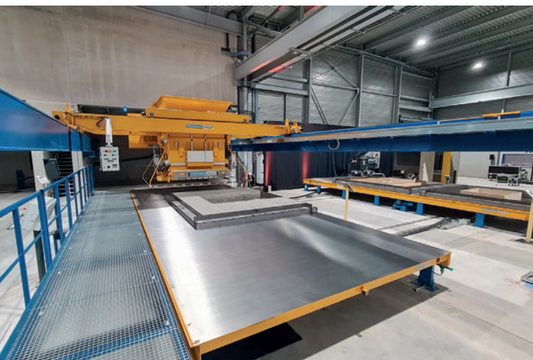
Новый бетонораздатчик служит для выгрузки древеснобетонной смеси
