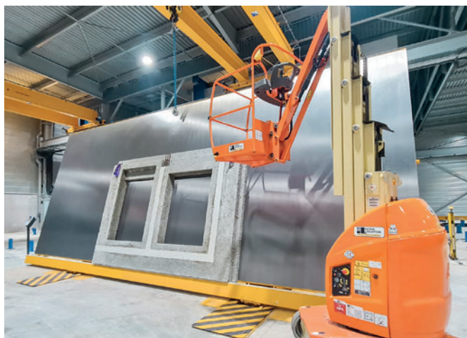
Кантовательное устройство в новом цехе приводит готовые стеновые элементы в вертикальное положение, обеспечивая надежную и удобную распалубку
