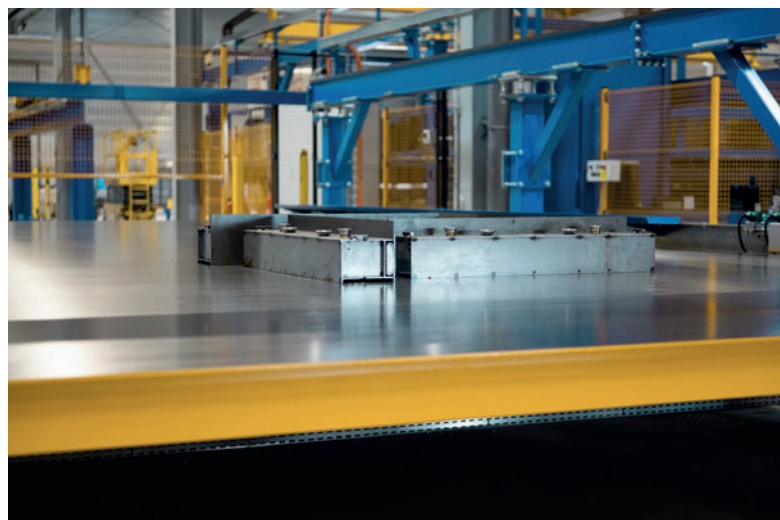
Центральный элемент линии на заводе Spurgin: опалубочная система PreFix
