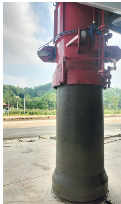
Pierwsza rura betonowa wyprodukowana za pomocą prasy radialnej RP 1225.
