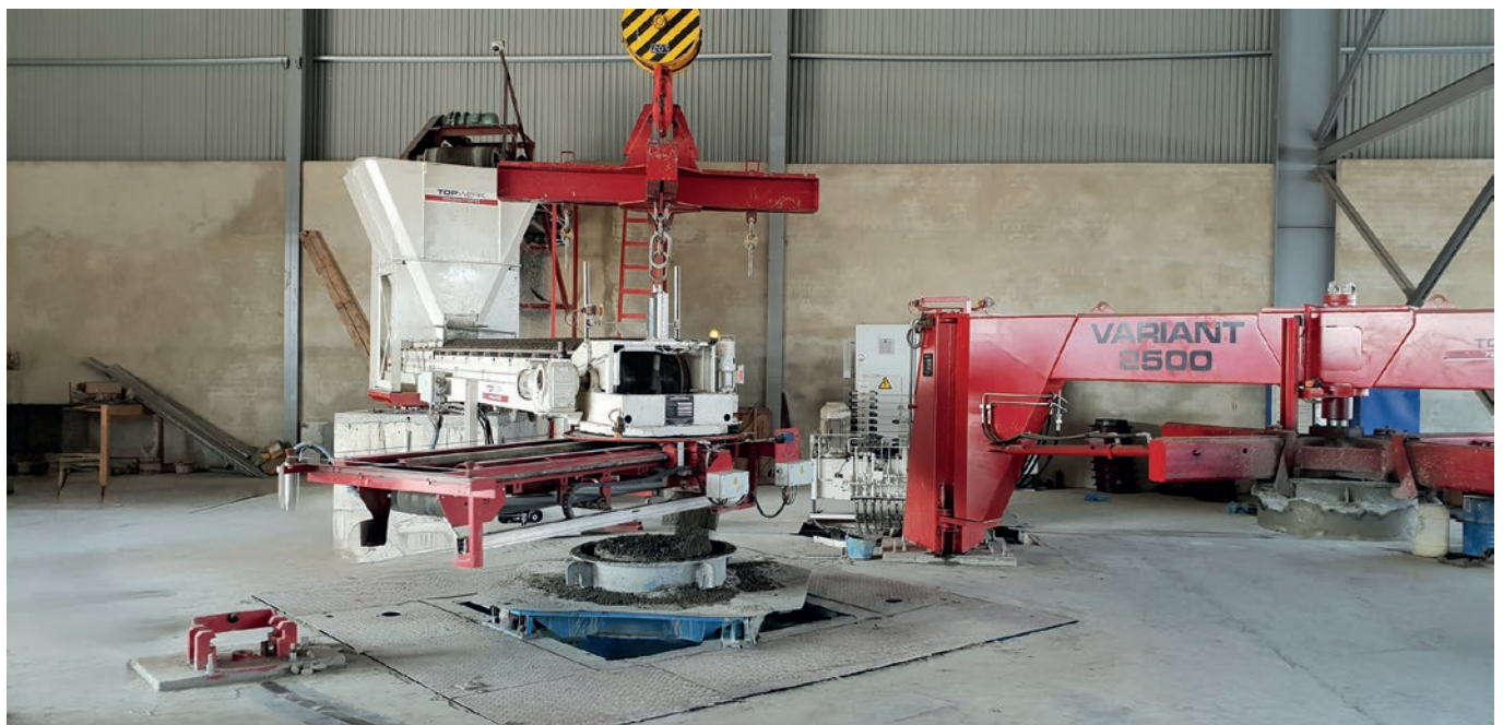
Maszyna Variant 2500D (dwustanowiskowa), rok budowy: 2018.
