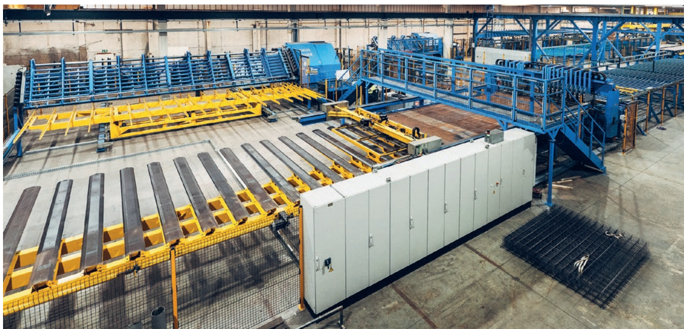
Linia zgrzewania siatek M-System PowerMesh produkuje duże ilości indywidualnie zaprojektowanych siatek z różnymi rozstawami prętów i zagięciami, zwiększając zarówno szybkość produkcji, jak i zdolności produkcyjne.
