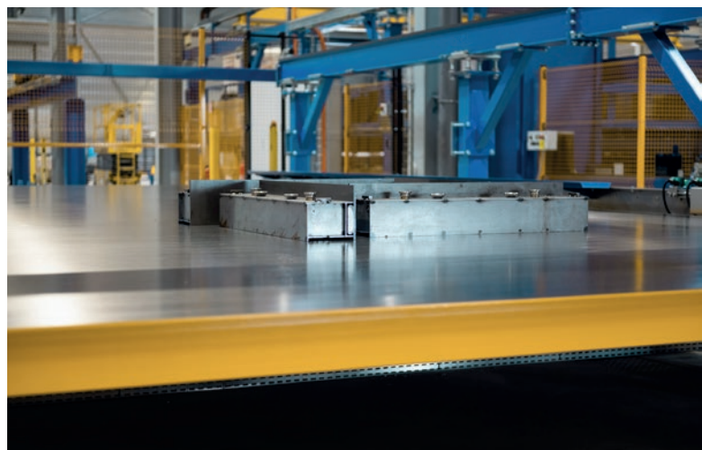
Kluczowym elementem nowej linii technologicznej Spurgin jest system szalunków PreFix.
