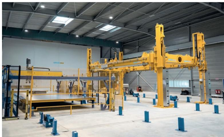
*Il nuovo ponte ribaltatore preleva due pallet contemporaneamente e li ruota di 180°. In questo modo è possibile applicare una struttura portante in calcestruzzo normale alla sommità dell'elemento misto legno-calcestruzzo.*
