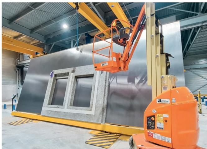
*Il telaio basculante del nuovo capannone porta gli elementi di parete finiti in posizione verticale, consentendo così una rimozione sicura e user friendly.*
