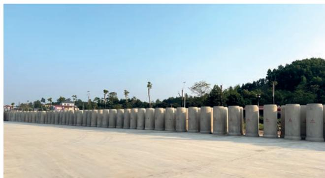
Stockage des tuyaux en béton fabriqués avec le système de compression radiale
