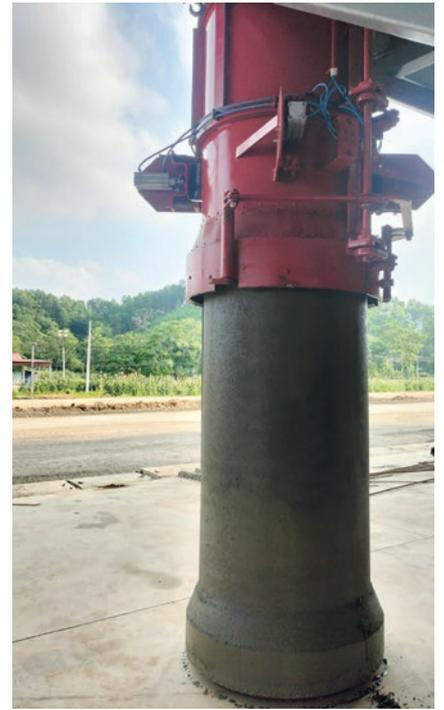
Fabrication de tuyaux grâce au système de compression radiale utilisé dans le monde entier
