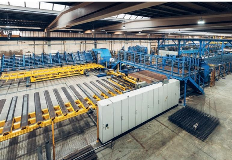
La ligne de soudage M-System PowerMesh produit des treillis sur mesure, en grandes quantités, avec des maillages et des angles de pliage flexibles, augmentant à la fois la vitesse et la capacité de production.
