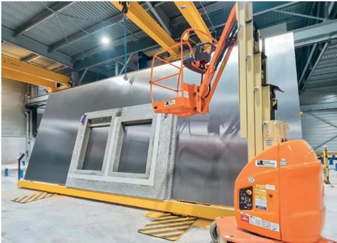
La table relevant dans le nouveau hall place les éléments de murs finis en position verticale, ce qui permet de les retirer en toute sécurité et avec une grande facilité d'utilisation.
