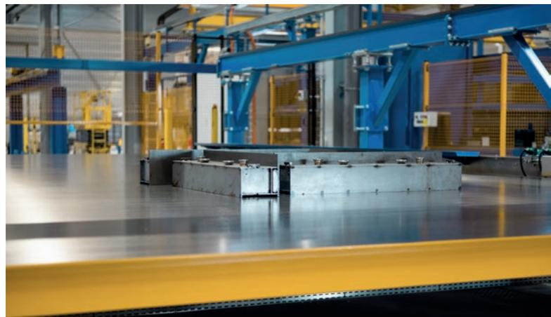
*La nouvelle pièce maîtresse de l'installation chez Spurgin : le système de coffrage PreFix.*
