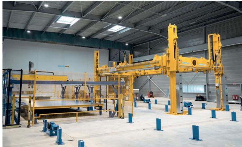
Grâce au nouveau dispositif de retournement, deux palettes sont prises en charge simultanément et retournées à 180°. Il est ainsi possible de renforcer le produit avec quelques renforts localisés en béton armé sur cet élément en béton de bois.
