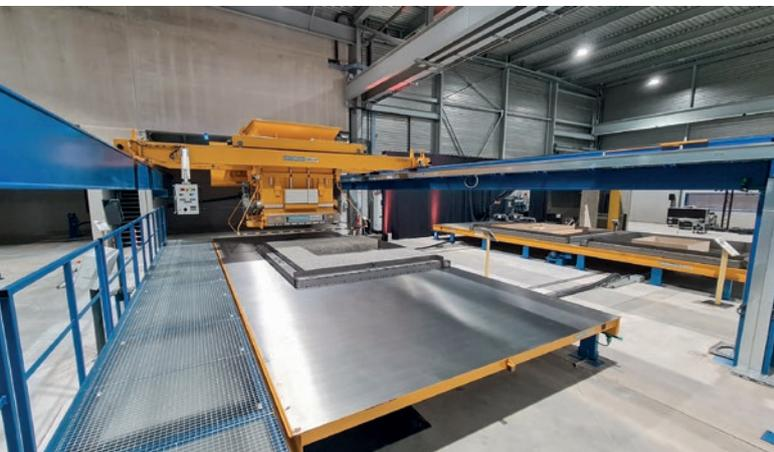
*Le distributeur de béton de conception nouvelle sert à verser le béton de bois.*
