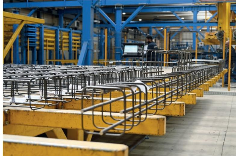
En Profit hay un paquete de diseño integrado con el que se pueden crear de forma rápida y sencilla mallazos y jaulas con plantillas previamente definidas
