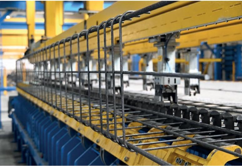
*El sistema de doblado de barras integrado garantiza una producción eficiente de jaulas de armadura*
