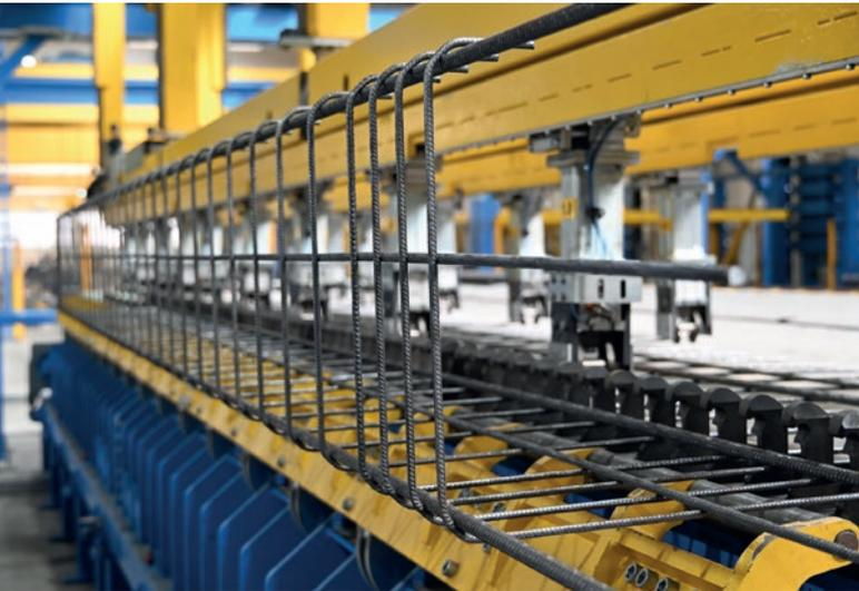
Das integrierte Balkenbiegesystem garantiert eine effiziente Produktion von Bewehrungskörben.
