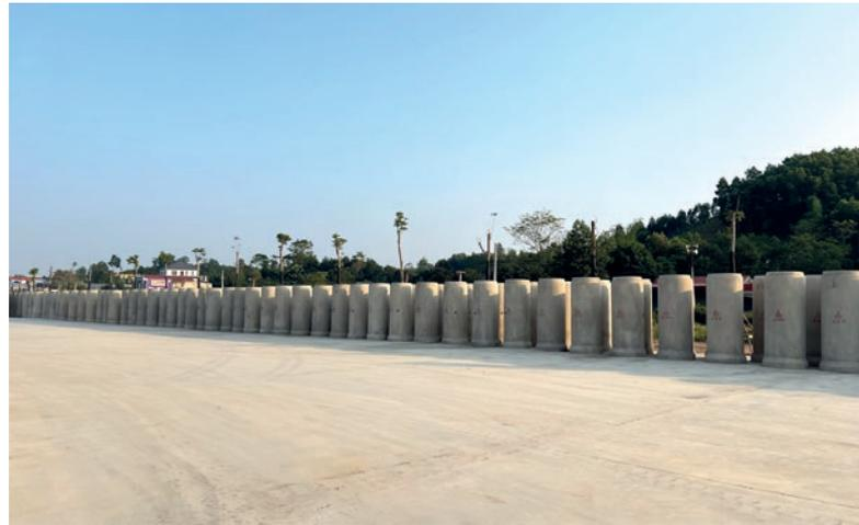
Lagerplatz für die mit dem Radialpressverfahren hergestellten Betonrohre
