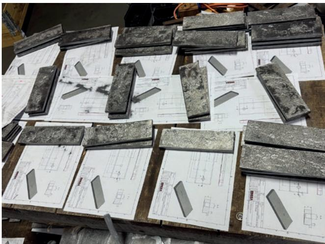
Druckplatten aus dem 3D-Drucker mit bossierten Oberflächen
